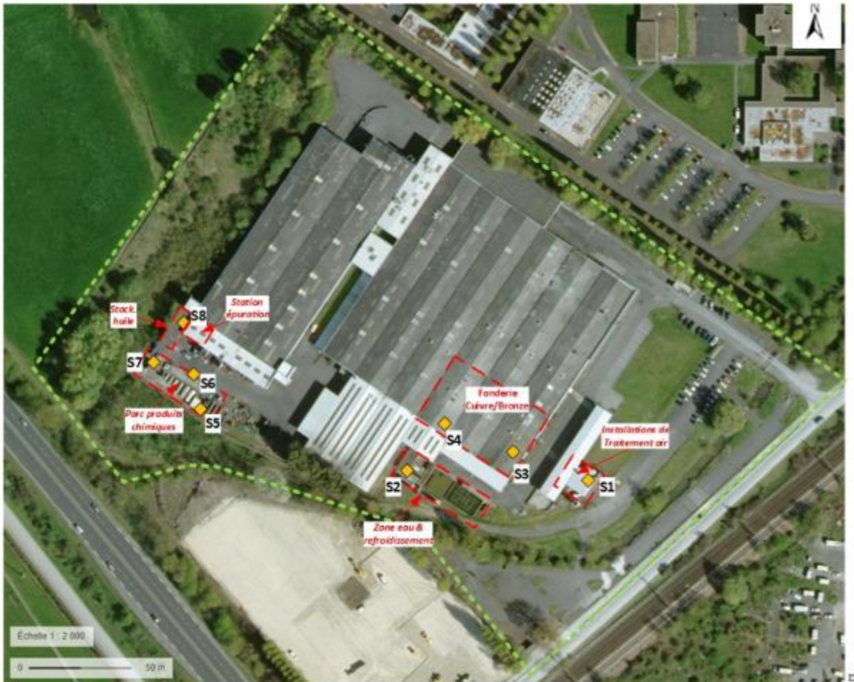
Figure 61 : Plan d'implantation des investigations de sols réalisés dans le cadre du rapport de base.
